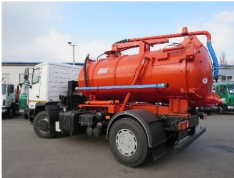
Рис. 4.4. Автомобіль муловсмоктувальний КО-503 ІВ-12
