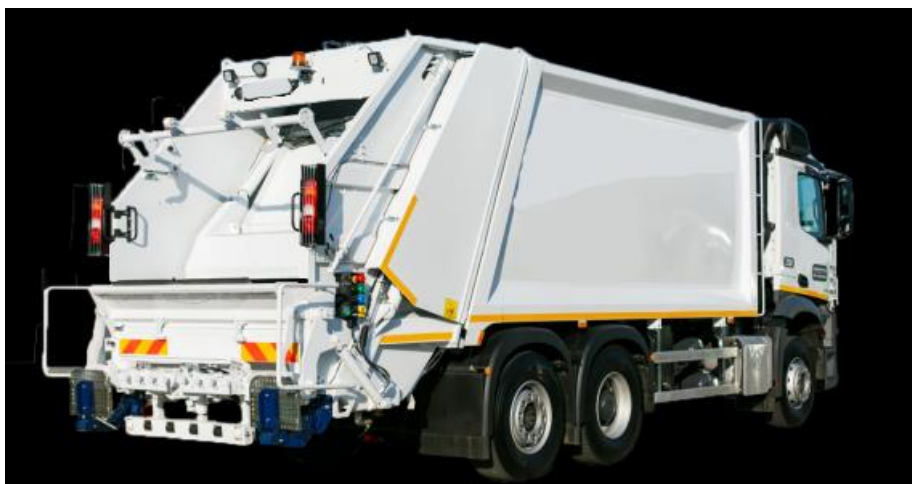
Рис. 2.2. Сміттєвоз з функцією миття та дезінфекції контейнерів
